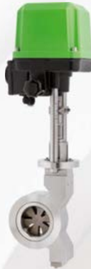
Segmentplattenventil mit Motorantrieb 5030 Nennweite: DN 25 - 300 Nenndruck: PN 25 (ab DN 250 PN 16) Werkstoff: Edelstahl (ab DN 150 auch in C-Stahl) Antrieb: Verschiedene elektrische Antriebe erhältlich, Absperr- und Stellantriebe, optionale Positions- regelung und Stellungsrückmeldung sowie Endlagenschalter
